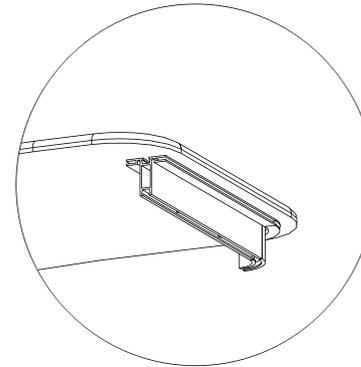
1/ Poser la tablette sur le comptoir monté et ajuster pour que les perçages soient en face des inserts filetés **FX866** (déjà intégré dans la tablette)
